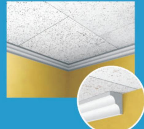
En todo el perímetro del local, se colocará la moldura T1T pegándola con una generosa cantidad de adhesivo relleno vinílico, tanto a la pared como al cielorraso. El mismo adhesivo se utilizará para el tomado de juntas donde sea necesario: entre molduras, entre pared y molduras, etc.
